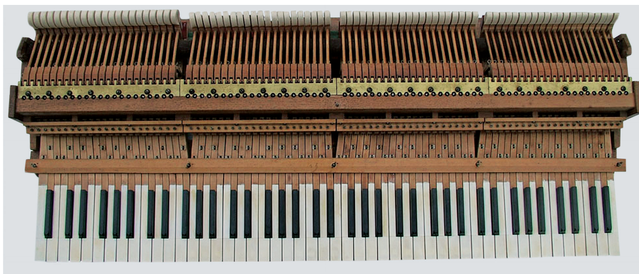
Fig. 13 Telaio della tastiera con castello della meccanica Keyboard frame and action Châssis du clavier avec l'ensemble de la mécanique
