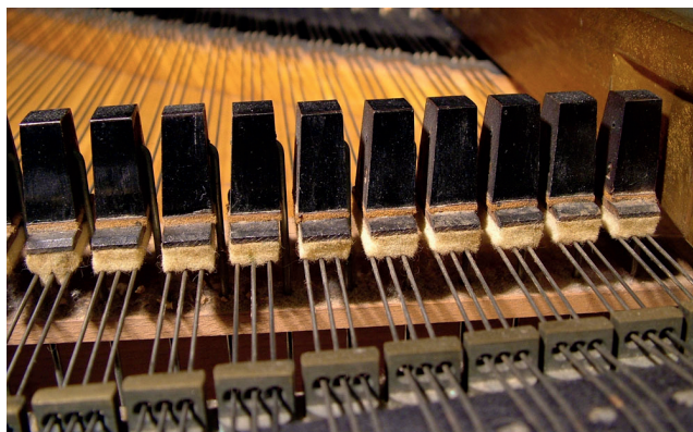
Fig. 23 Teste degli smorzatori delle note La_1-Fa\sharp_0 Damper heads ( A_2-F\sharp_1 )
