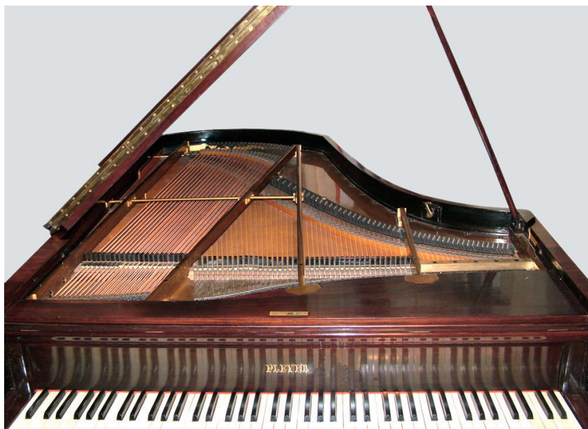
Fig. 8 Telaio metallico di rinforzo esterno (visione frontale) The outer reinforcing frame (front view) Châssis métallique de renfort externe (vue frontale)
